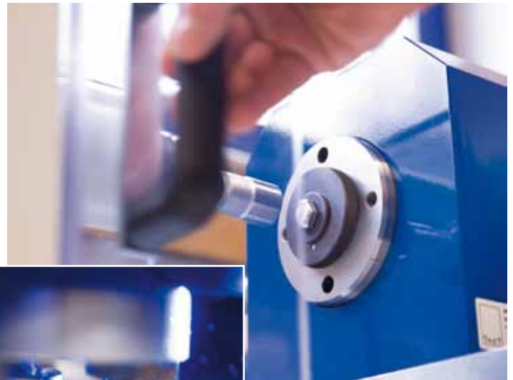
Aufwändige Testmethodik – Reibwertmessung und Schliffbilduntersuchungen zur Qualitätssicherung
