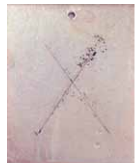
Im Salzsprühetest nach Ritzspur ist der Selbstheilungseffekt deutlich erkennbar.
