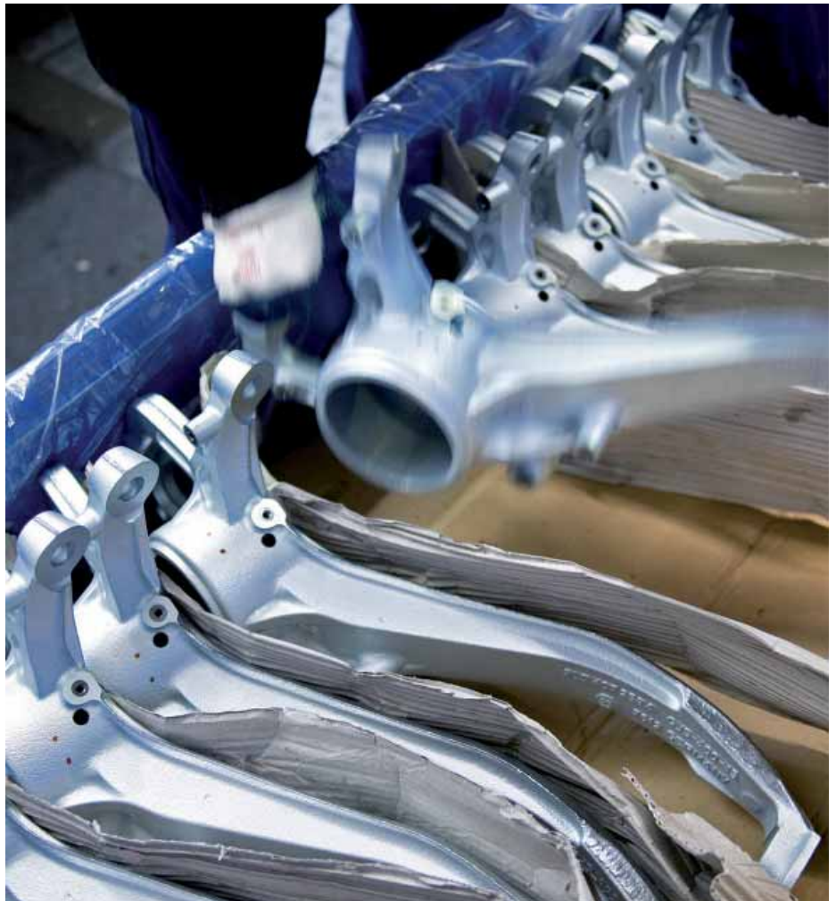
Zeschky galvanisiert Schwenklager eines Premium-SUVs von VW und veredelt diese mit einer Nano-Beschichtung. Vorab strahlt KST die Produkte.
